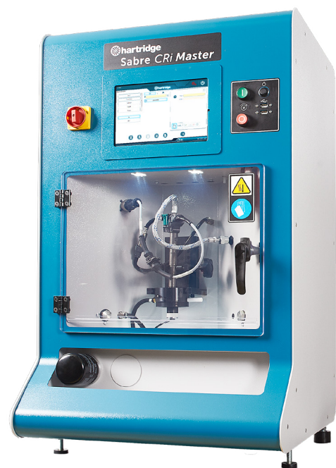
Система тестирования инжекторов модели Sabre CRi Master
